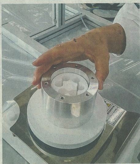
六つの槽で原料をかくはんし、薬品を合成する小型プラント
