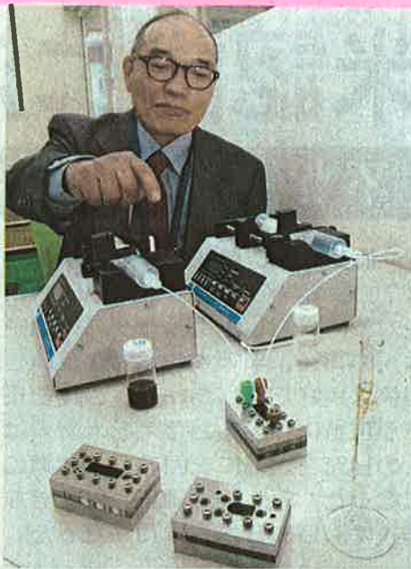
マックエンジニアリングが製造する規格品タイプのマイクロリアクター(手前の二つ)と、ポンプなどをセットした実験ユニット(奥)
